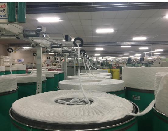
**2.** Die gepressten Baumwollballen werden von einer Maschine zerpfückt und die Faserklumpen zu losen Fasern für die weitere Verarbeitung gelöst.
